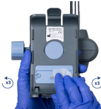
Abbildung 12.1. Reinigen der elektrischen Anschlüsse
