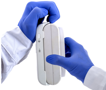
Abbildung 2.21. Lösen der Sapphire Connect-Einheit von der Sapphire-Pumpe
