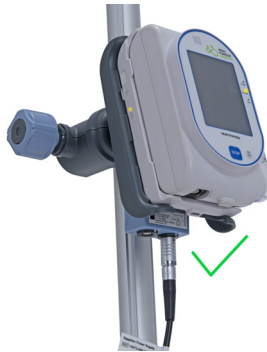
Abbildung 2.18. Laden der Sapphire Connect-Einheit über eine Ministation
