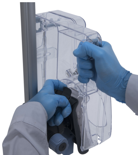
Abbildung 2.14. Entfernen der Schließkassette vom Infusionsständer bei Verwendung mit der Sapphire Connect-Einheit
