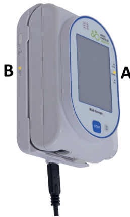
Abbildung 2.29. Laden der Sapphire-Pumpe über die Sapphire Connect-Einheit
